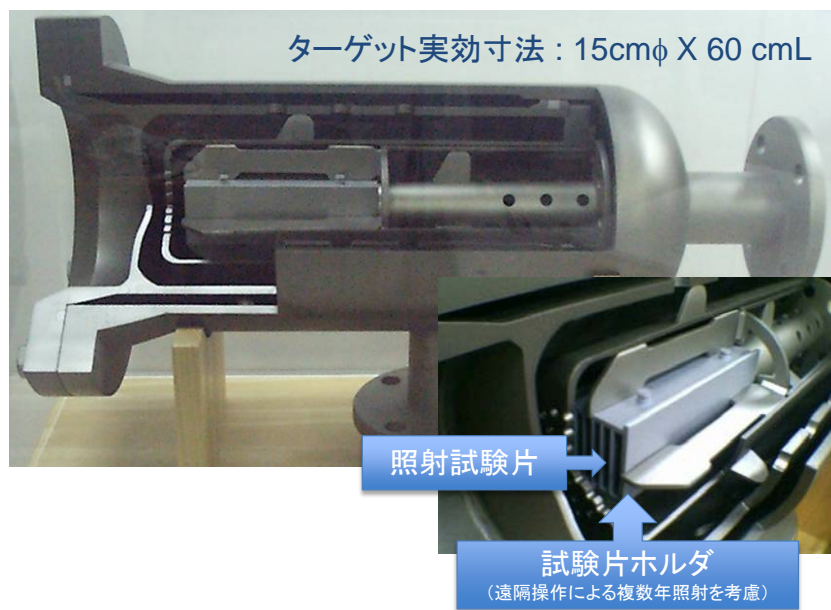
ADSターゲット試験施設の 候補ターゲット概念(2重管型)
